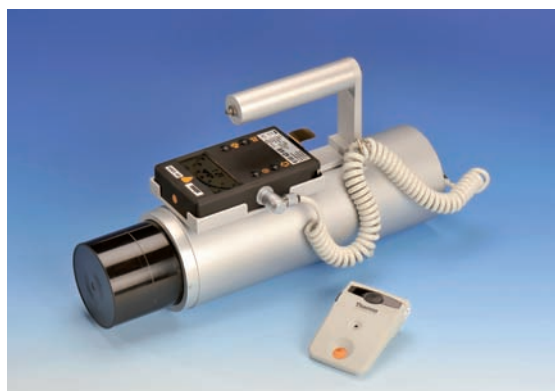
Bild 1: Beispiel für ein Orts- und ein Personendosimeter
