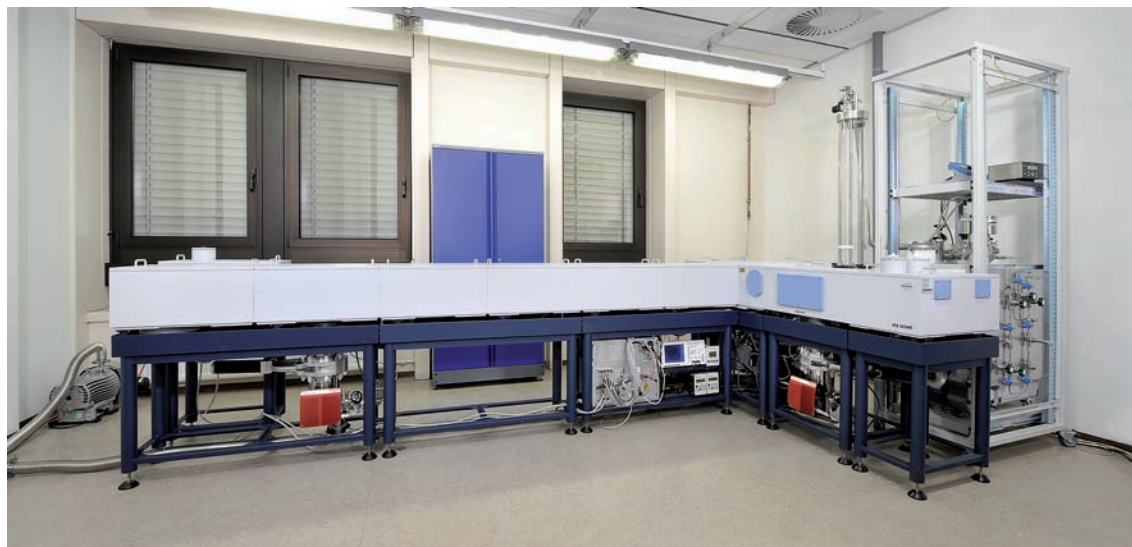
Zentrallabor der europäischen Spektralparameter-Infrastruktur in der PTB: Fourier-Transform-Infrarotspektrometer (Bruker IFS-125) mit einer spektralen Auflösung von \Delta\nu = 10^{-3} \text{ cm}^{-1}
