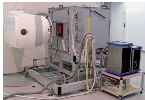
Bild 2: Das Wasserkalorimeter vor dem Strahlerkopf des medizinischen Beschleunigers der PTB. Das Außengehäuse (Kantenlänge ca. 1 m) dient zur Temperaturstabilisierung des bei 4°C betriebenen Kalorimeters. Das rot umrandete Feld markiert das Strahlungseintrittsfenster des Kalorimeters.
