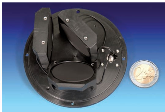
Blick ins Innere des neuartigen Terahertz-Detektors: ein durch PTB-Patent geschützter kompakter Aufbau als Strahlungsfalle mit drei Sensorelementen erfasst die im Terahertz-Spektralgebiet typischen, großen Reflektionsverluste eines einzelnen Sensorelements.
