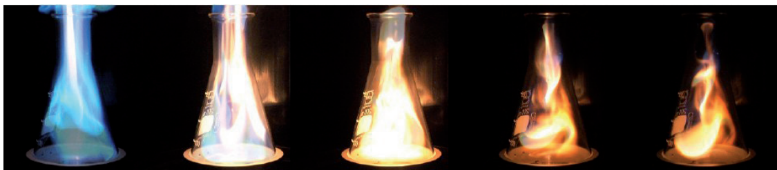
Bild 2: Entzündung eines Kohlenwasserstoff/Luft-Gemisches in Anlehnung an die Zündtemperaturbestimmung nach DIN EN 14522
